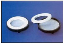
Abb. 2: Perfusionszellkammer und Zellträger, System der Minucells and Minutissue Vertriebs GmbH
